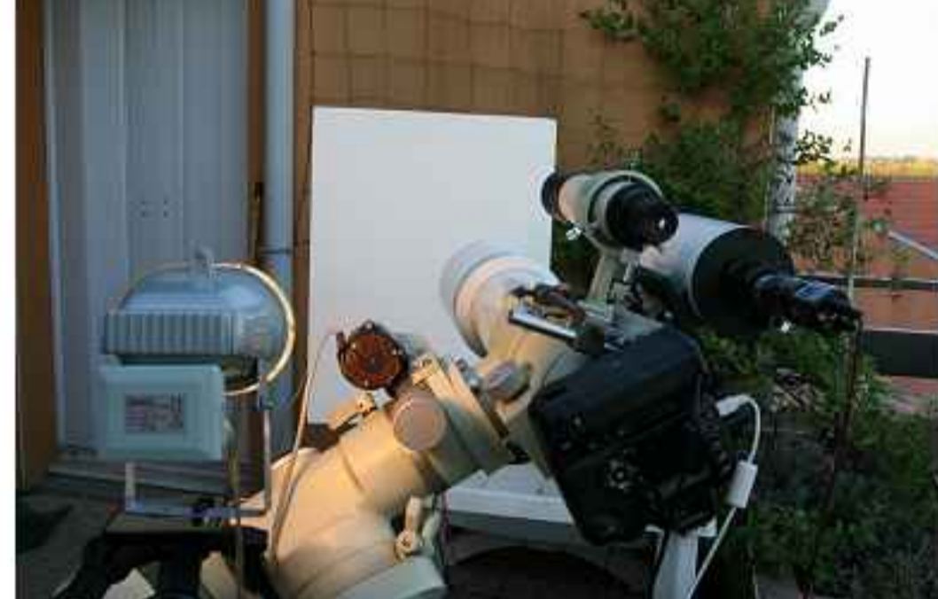
Acquisition des plages de lumière uniforme (Bats) afin d'enlever le vignettage des images.
